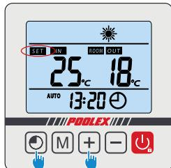
Drücken Sie + fünf Sekunden lang gleichzeitig, die Kontrollleuchte blinkt schnell, die Steuereinheit ist bereit für die Kopplung.
