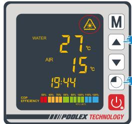
Druk tegelijkertijd gedurende 5 seconden op + LED knippert snel, de schakelkast is klaar om te worden gekoppeld.
