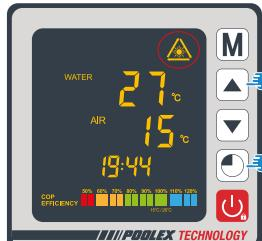
Drücken Sie + fünf Sekunden lang gleichzeitig, die Kontrollleuchte blinkt schnell, die Steuereinheit ist bereit für die Kopplung.
