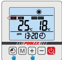
Druk gedurende 5 sec tegelijkertijd op + , LED knippert snel, de schakelkast is klaar om te worden gekoppeld..
