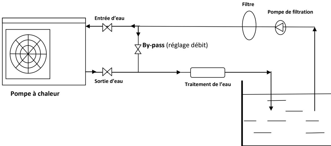
**NOTA :** La pompe à chaleur est livrée avec deux raccords unions diamètre 50, 4 cylindres blocs, un récupérateur de condensat, un moniteur de commande et son coffret, une notice. Le reste de l'installation : vannes, by-pass, pompe, etc., est à fournir par l'installateur.
