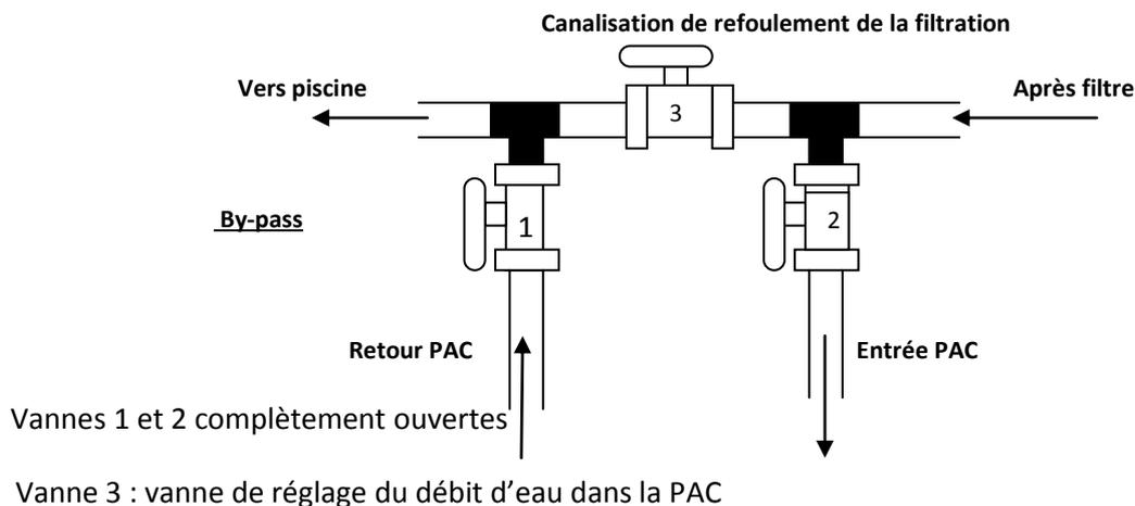
Toujours connecter les électrolyseurs, les régulateurs de PH ou tout autre traitement après le By-pass de la pompe à chaleur.
